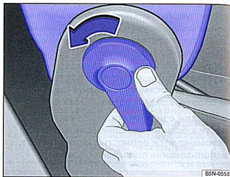
Илл. 56 Разблокировка складной спинки сиденья переднего пассажира
