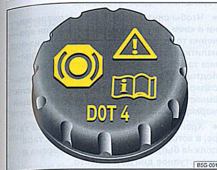
Илл. 144 В моторном отсеке: крышка бачка с тормозной жидкостью.
