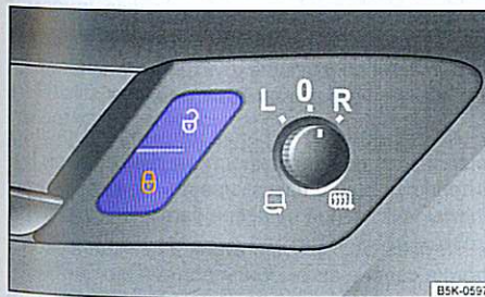
Илл. 29 На двери водителя: клавиша центрального замка.
