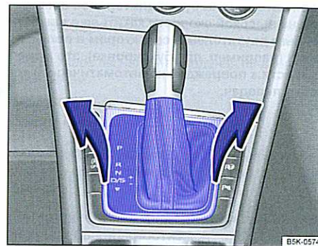
Илл. 214 Снятие крышки кулисы.
