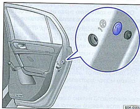
Илл. 210 На торце задней правой двери: закрытый резиновой заглушкой аварийный замок.
