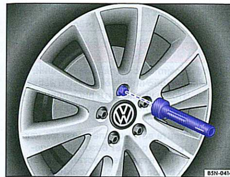
Илл. 226 Замена колеса: выворачивание колёсных болтов ручкой отвёртки.
