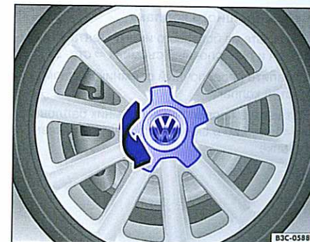
Илл. 219 Откручивание колпака ступицы.
