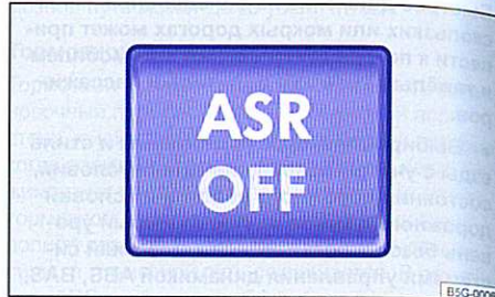
Илл. 143 Кнопка выключения и включения ASR на центральной консоли (автомобили без ESC).
