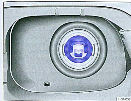
Илл. 189 При открытом лючке горловины топливного бака: защита от заправки неподходящим типом топлива, расположенная в самой заливной горловине топливного бака.
